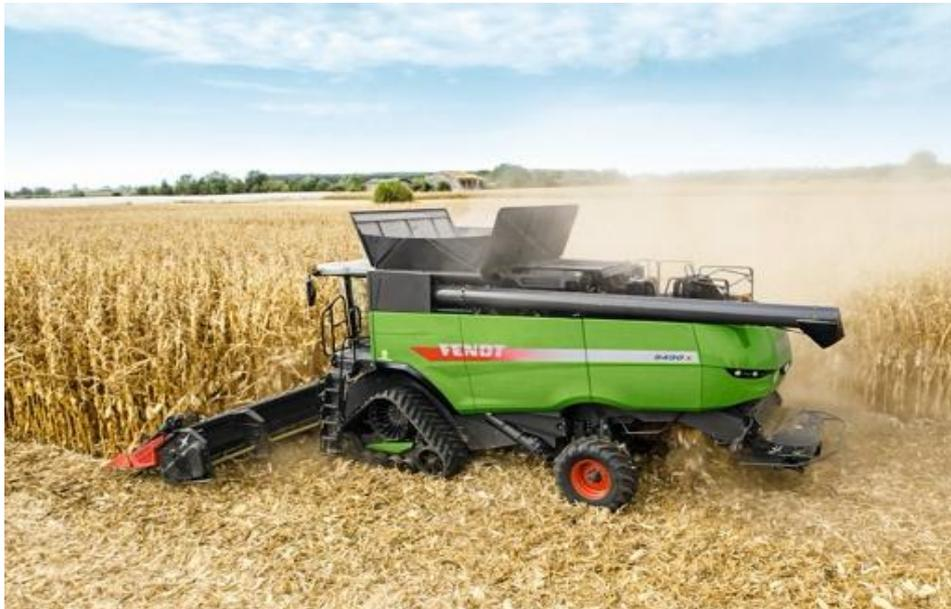
**Macchina sfalcia- trincia- caricatrice per la raccolta della pianta intera di mais**
